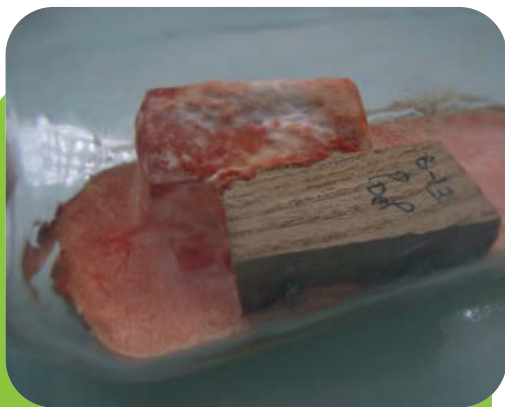
Essai de résistance naturelle du bois de mûrier au champignon tropical Pycnoporus sanguineus . © N. Leménager, Cirad
