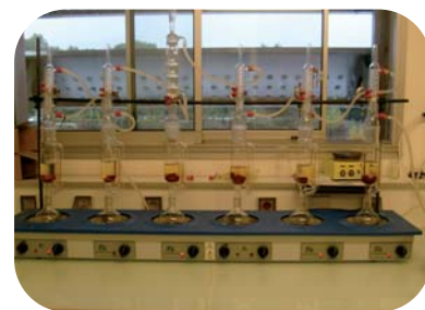
Extraction de métabolites secondaires du bois à l'aide d'un appareil de Soxhlet. © N. Nkolo, Cirad
